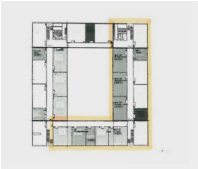
Bauabschnitt 1: Sanierung West- und Nordflügel mit Insellösung Brauer
