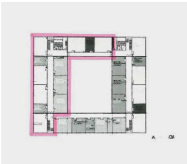
Bauabschnitt 2: Sanierung Ost- und Südflügel mit Insellösung Drucktechnik und Friseure
